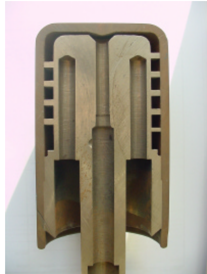
Abb. 3.4: Schnittmodell eines Plungers
