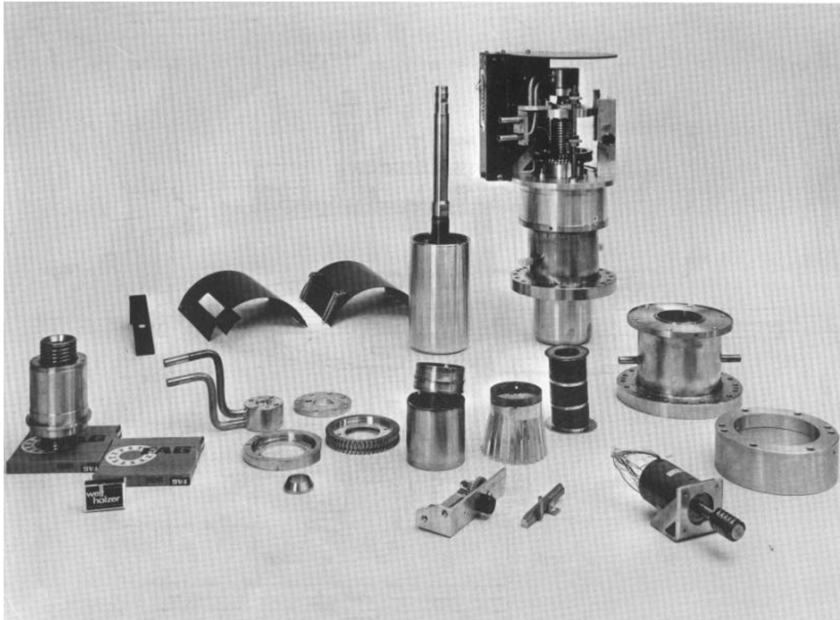
Abb. 4 Frequenzabstimmstempel ohne Abdeckhaube sowie Einzelteile vor der Montage
