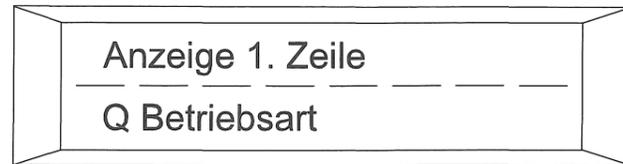
Zur freien Einstellung beider Anzeigezeilen. Zusätzlich kann gewählt werden, ob die 2. Zeile im Multiplexbetrieb arbeiten soll.
